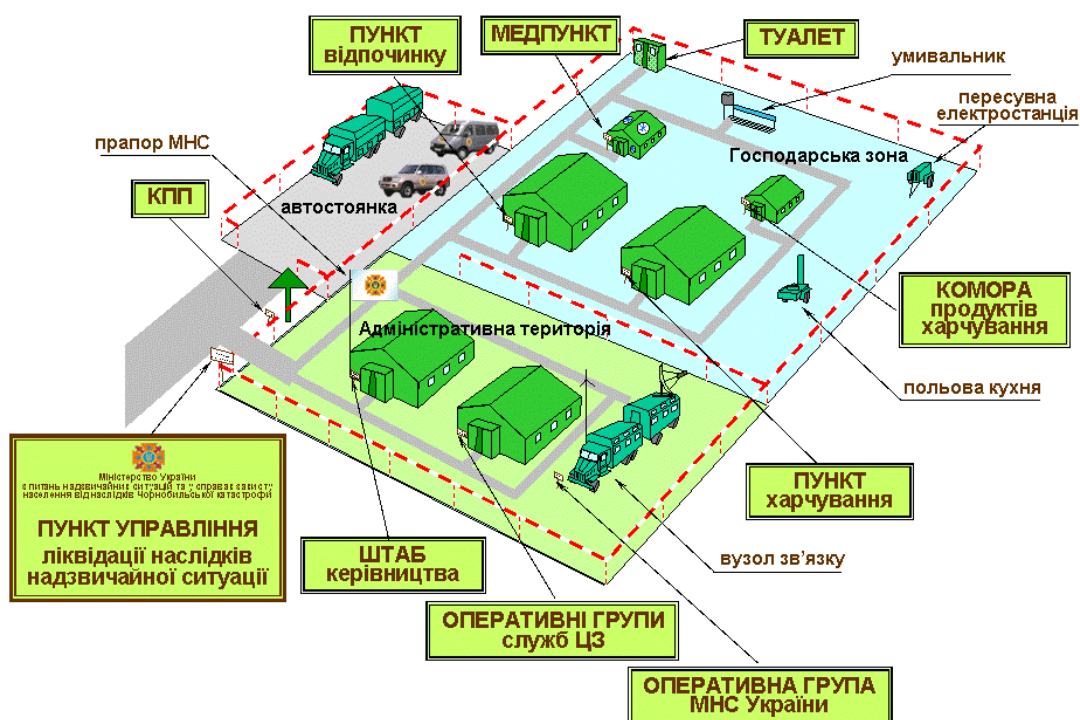
Рис.6. Варіант розгортання пересувного пункту управління
