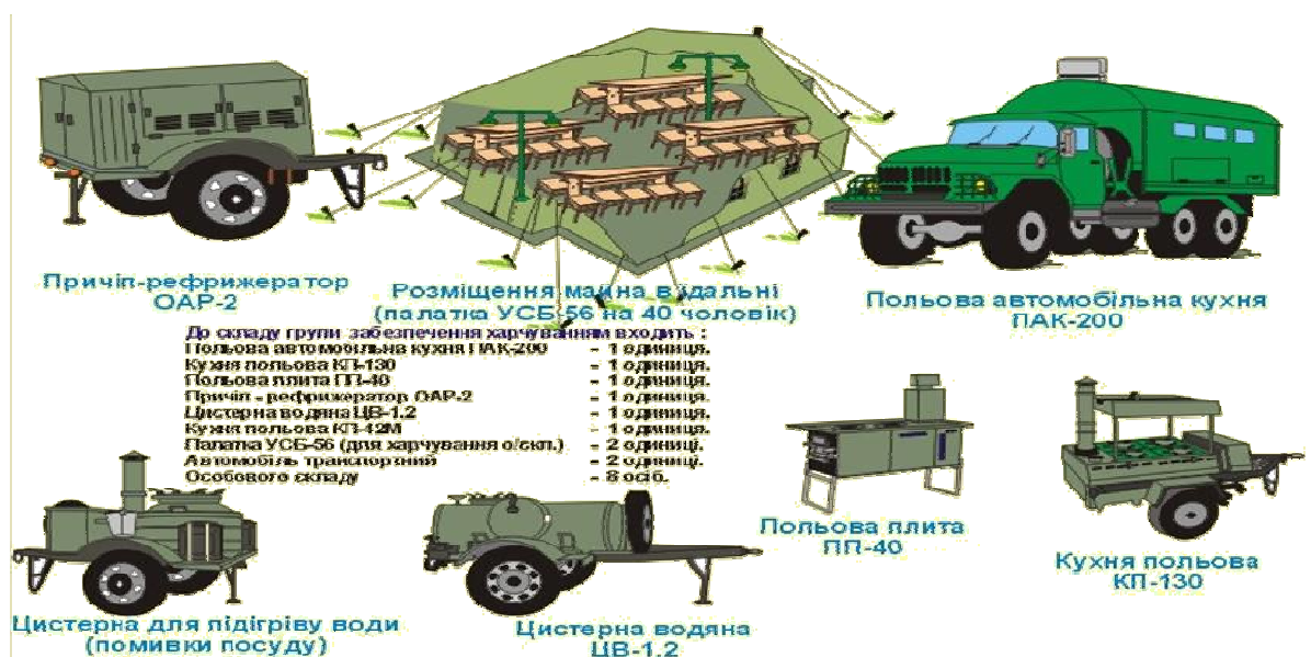
Рис.13. Обладнання групи харчування
