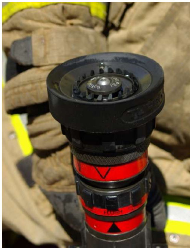
Фот. 1, 2: Зліва: пожежний ствол виставлений на витрату 115 л/хв і розпилений струмінь. Справа: пожежний ствол виставлений на функцію промивання („flush”) і розпилений струмінь. Переміщення стержня змінює загальну поверхню витoku для подавання води, що діє незалежно від персня, регулюючого форму витoku струменя води.
