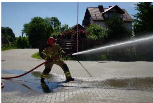
Фот. 35, 36, 37, 38: Спосіб подавання суцільного струменя великої витрати. У випадку моделі Akron 1720 витрата гранична і становить 475 л/хв (7,9 л/с). Вкладання рукавної лінії та позиція, описана в тексті вище, уможлиблює вільну роботу впродовж довгого часу і мінімізацію фізичних зусиль.
