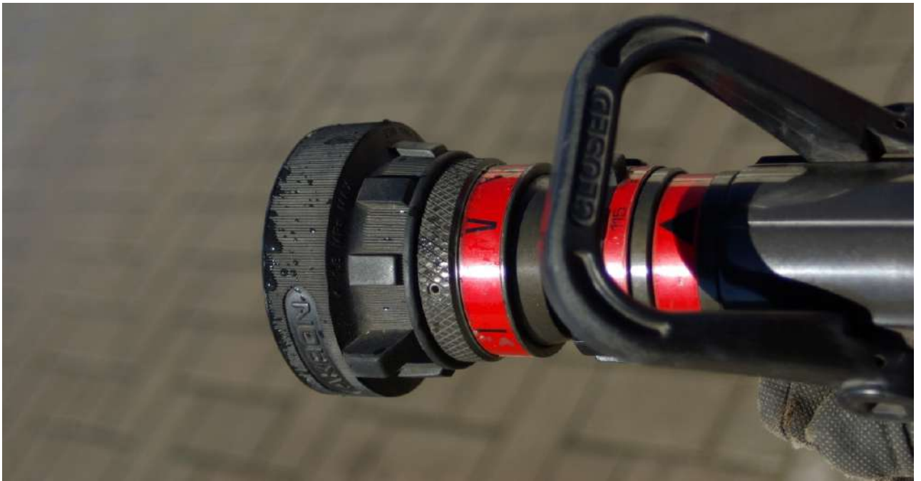
Фот. 22: Наближений вигляд налаштувань ствола для виконання способу подавання короткого пульсу. Великою перевагою моделі Akropon 1720 є те, що, завдяки налаштуванням, які позначено виробником, можна досить детально встановити всі необхідні параметри струменя (витрата, кут розпилення). Це є особливість, яка вкрай рідко зустрічається серед інших стволів такого типу і дає можливість на детальнішу, а відповідно, безпечнішу й ефективнішу роботу пожежника в умовах обмеженої видимості, стресу, дефіциту часу і т. п.
