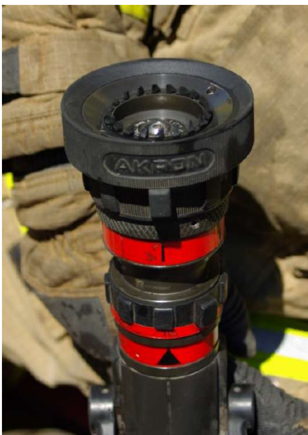
Фот. 3, 4: Зліва: пожежний ствол виставлений на витрату 115 л/хв і суцільний струмінь. Справа: пожежний ствол виставлений на функцію промивання („flush”) і суцільний струмінь. Переміщення стержня змінює загальну поверхню витoku для подавання води, що діє незалежно від персня, регулюючого форму витoku струменя води.
