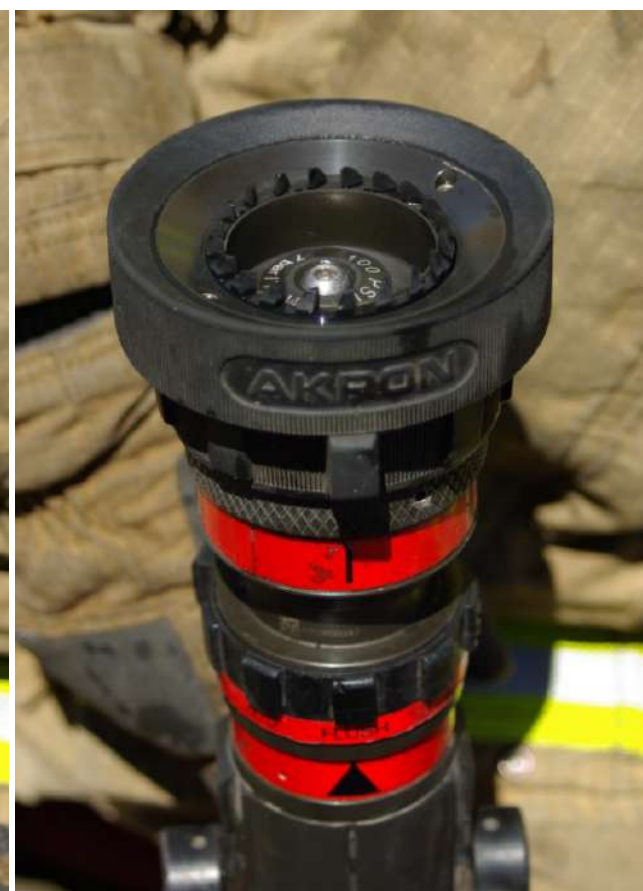
Фот. 3, 4: Зліва: пожежний ствол виставлений на витрату 115 л/хв і суцільний струмінь. Справа: пожежний ствол виставлений на функцію промивання („flush”) і суцільний струмінь. Переміщення стержня змінює загальну поверхню витoku для подавання води, що діє незалежно від персня, регулюючого форму витoku струменя води.
