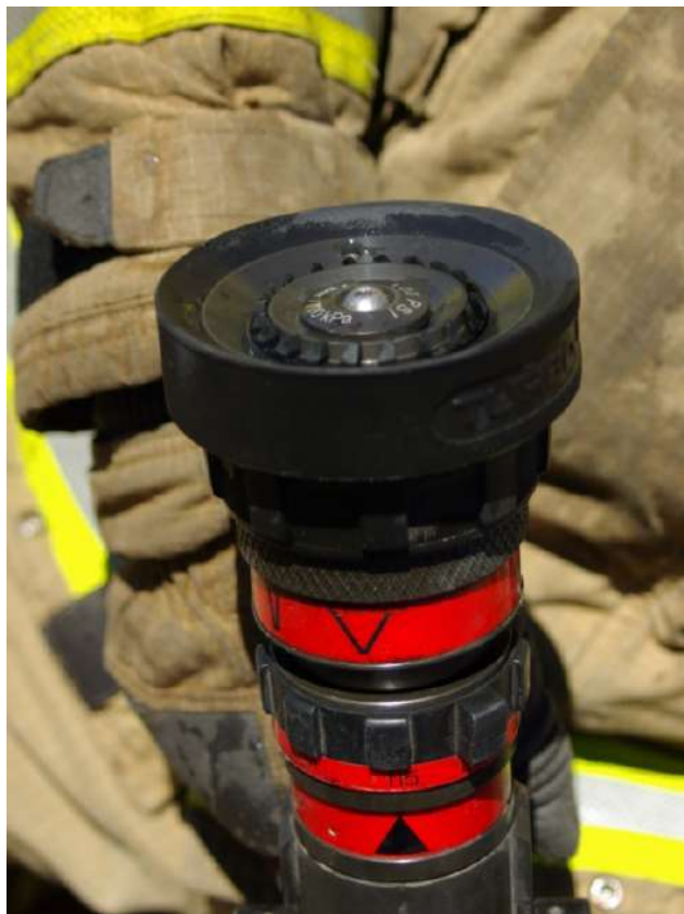
Фот. 1, 2: Зліва: пожежний ствол виставлений на витрату 115 л/хв і розпилений струмінь. Справа: пожежний ствол виставлений на функцію промивання („flush”) і розпилений струмінь. Переміщення стержня змінює загальну поверхню витoku для подавання води, що діє незалежно від персня, регулюючого форму витoku струменя води.
