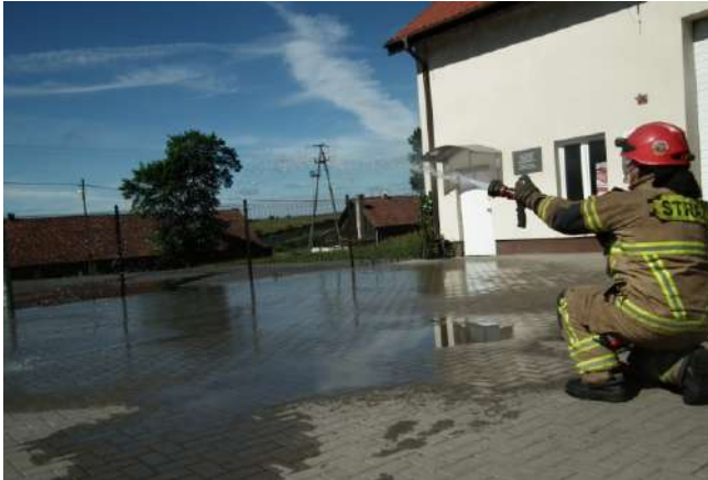
Фот. 31, 32, 33, 34: Спосіб малювання , тобто подача наливом невеликої кількості води при неповному і плавно змінюваному відкритті ствола з метою охолодження нагрітих горючих поверхонь.
