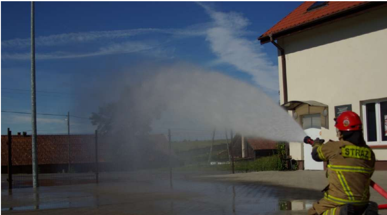
Фот. 25: Правильне виконання довгого пульсу з іншої перспективи, яке показує глибину подачі водяного туману. Видно, що вся вода є спрямована і потрапляє в об'єм задимлення – вище голови ствольника. Завдяки відповідному куту розпилення, досягається глибоке поширення (охолодження). З іншого боку, уникнення малого кута розпилення дозволяє запобігти об'єднанню капель туману і надто швидкому спаданню в нижній частині струменя або прольоту через дим і затримання на стінах чи стелі (без ефективного охолодження) у верхній частині струменя.
