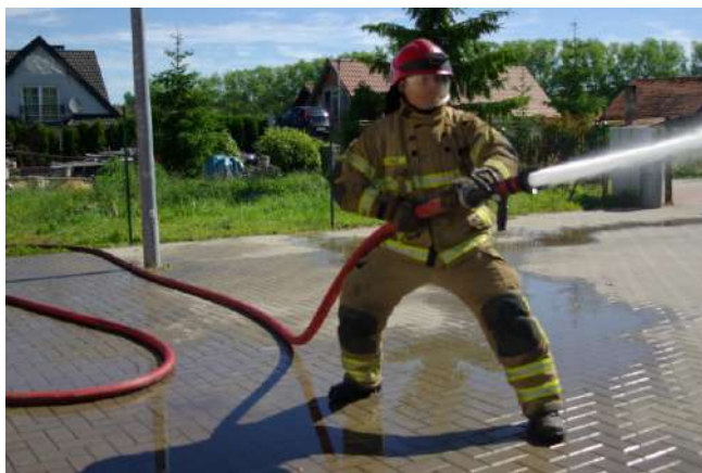
Фот. 35, 36, 37, 38: Спосіб подавання суцільного струменя великої витрати. У випадку моделі Akron 1720 витрата гранична і становить 475 л/хв (7,9 л/с). Вкладання рукавної лінії та позиція, описана в тексті вище, уможлиблює вільну роботу впродовж довгого часу і мінімізацію фізичних зусиль.
